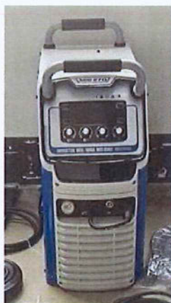
Aparat saldimiti CO2, rryma e saldimit: 30 - 250A diametri i telit të saldimit: Ø 0.6 - 1.2mm
